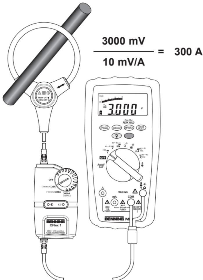
Bild 2 b: Wechselstrommessung
