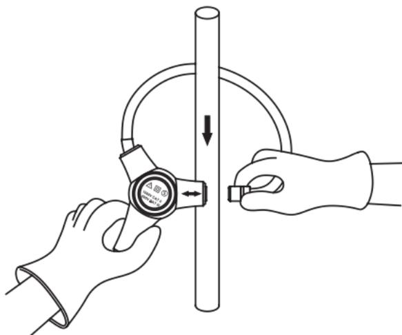
Bild 2 a: Wechselstrommessung
